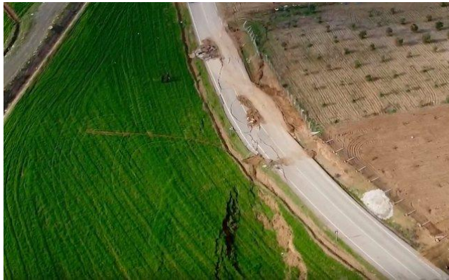
Şekil 13: Karayolu üzerinde meydana gelen ötelenme sonucunda ortaya çıkan deformasyonun havadan görünümü.
